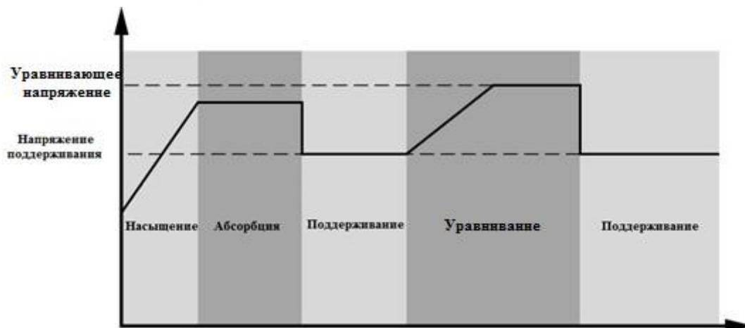
В режиме уравнивания контроллер подает ток заряда как обычно, пока напряжение не достигнет напряжения уравнивания. Затем напряжение останавливается на заданном уровне и поддерживается на протяжении нескольких, указанных в настройках, минут.
