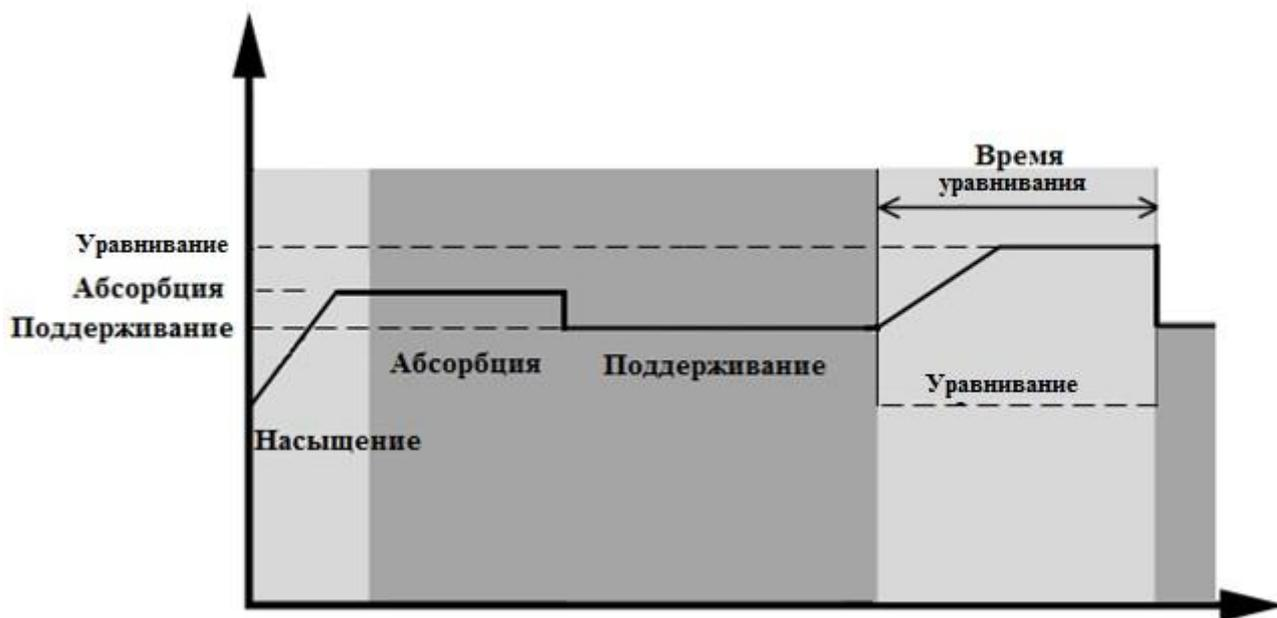
Однако бывает так, что при уравнивании за время, указанное в настройках, напряжение аккумулятора не поднялось до напряжения уравнивания аккумулятора. Контроллер заряда сам продлит время уравнивания, пока аккумулятор не достигнет заданного напряжения. Если напряжение аккумулятора все равно осталось ниже, чем напряжение уравнивания и режим уравнивания остановится, контроллер заряда перейдет в режим поддерживающего заряда.
