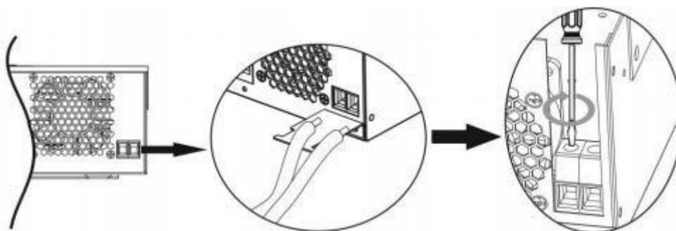
5. Проверить, надежно ли подключены провода, зафиксируйте хомутом провода к прижимной пластине.
